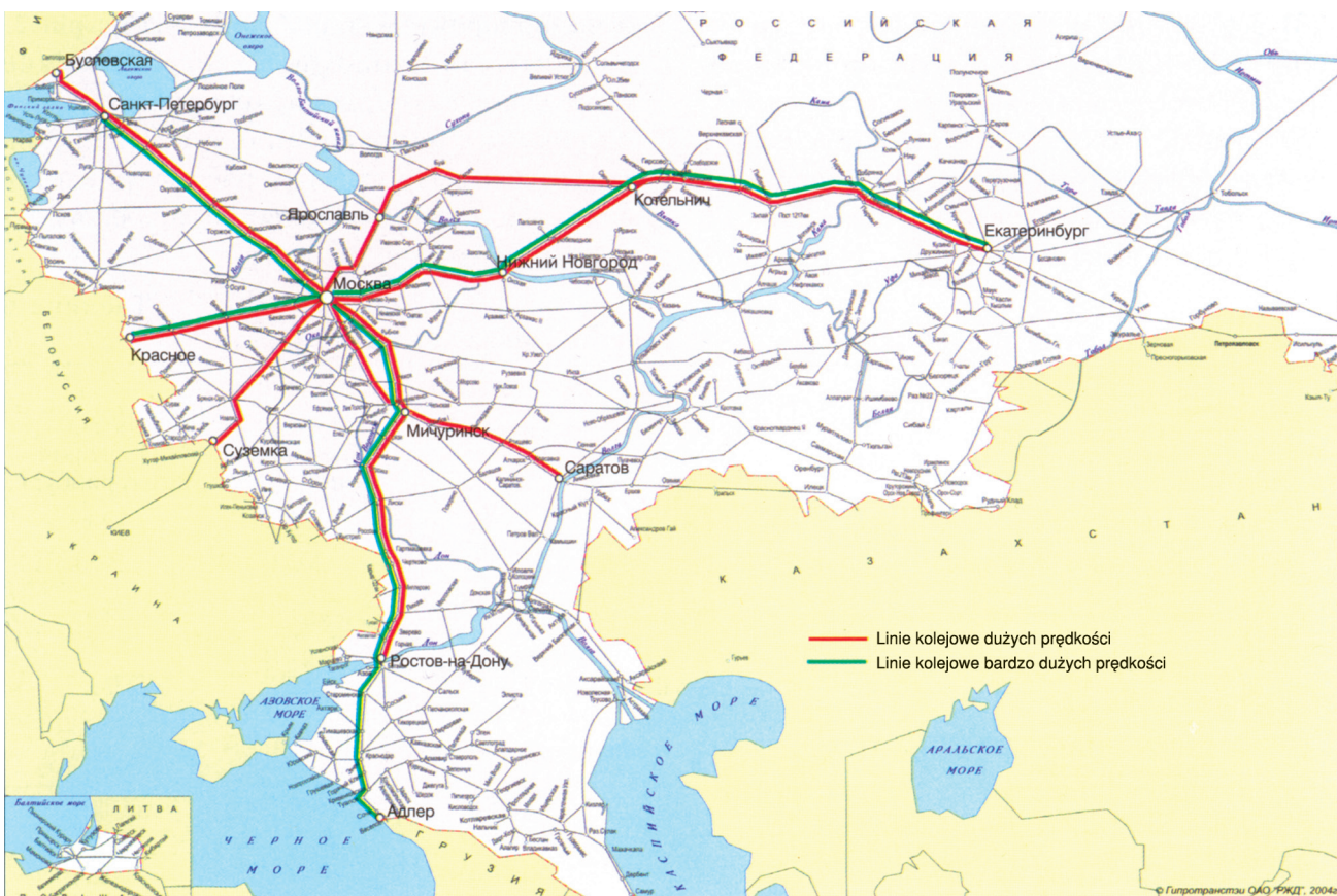
Rys. 1. Schemat linii kolejowych dużych (160–200 km/h) i bardzo dużych (350 km/h) prędkości
