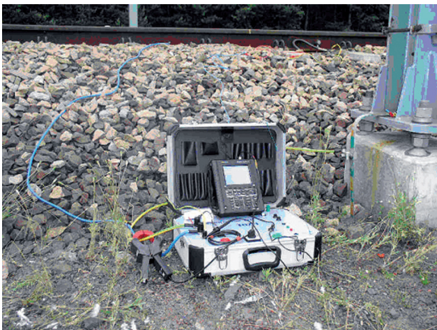
Rys. 7. Układ pomiarowy do badania zwierników TZD w terenie
