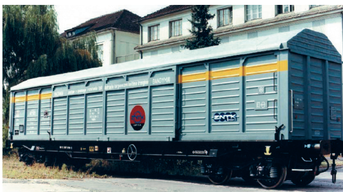
Rys.11. Wagon towarowy typu 413K serii Haikks z wózkami 4RS/N
