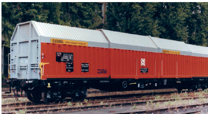
Rys.10. Wagon towarowy typu 426Sc z wózkami 4RS/N
