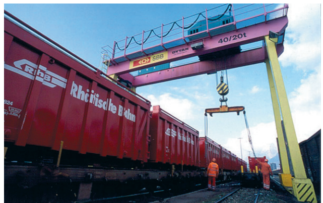
Fot. 5. Podjęcie suwnicą pojemników ACTS z wagonu typu R-w kolei Rhätische Bahn AG [14]
