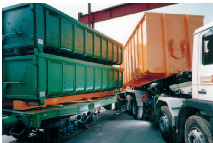
Fot. 6. Wagon Sips-x do transportu w systemie ACTS kolei SBB i sposoby wyładunku [8]; rozładunek transportem samochodowym
