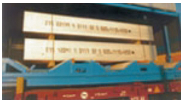
Fot. 8. Wagon Salmpps-x 704 do przewozu ciężkich pojemników zawierających taśmy aluminiowe w kręgach [7, 15, 16]
