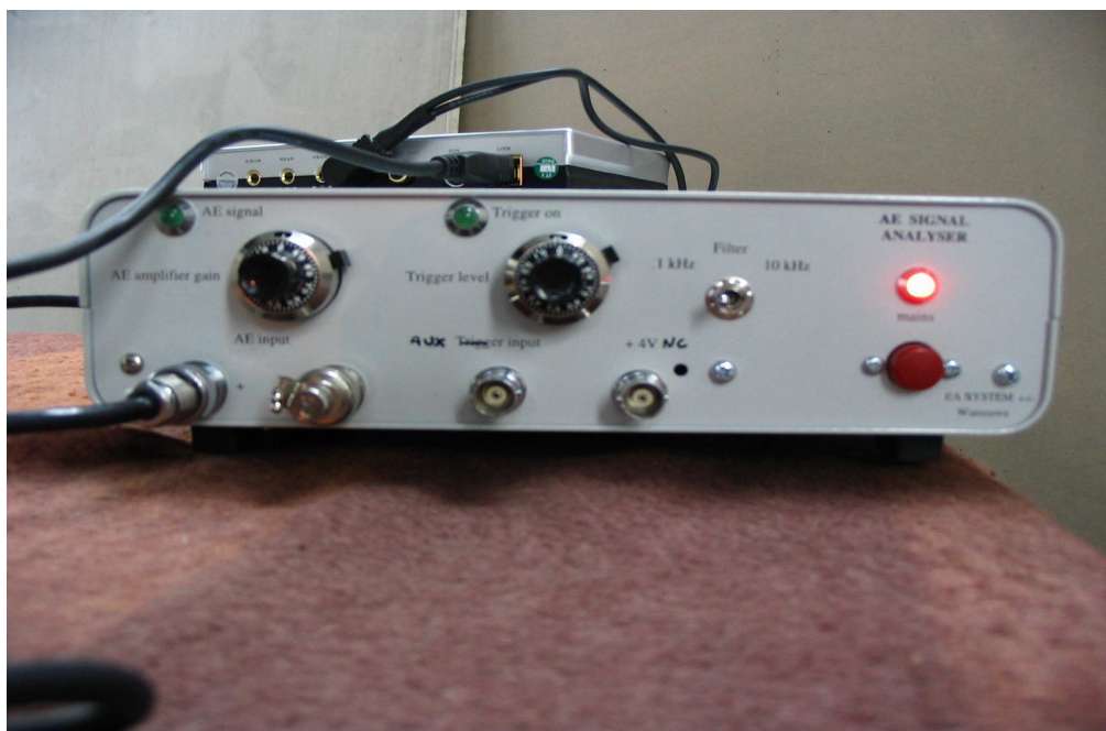
Fig. 2. Vibroacoustic signal analyser, used in the investigation, connected to the USB external soundcard Rys. 2. Analizator sygnału wibroakustycznego, stosowanego w badaniach, połączony do łącza USB zewnętrznej karty dźwiękowej
