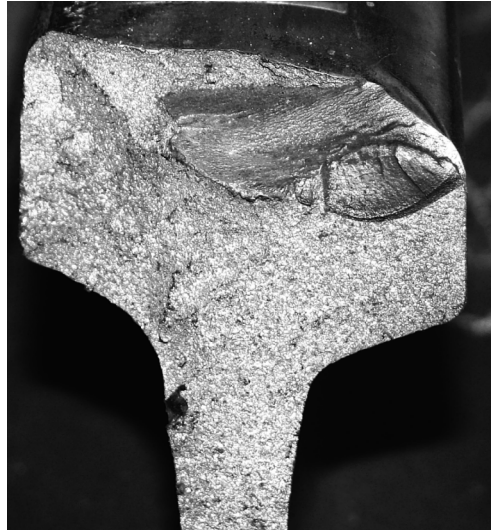
Rys. 4. Pęknięcie zmęczeniowe w jednym z przełomów szyny na szlaku Wronki–Miały . Zmniejszenie wskaźnika wytrzymałości tej szyny wynosi wskutek tego pęknięcia ok. 13 %.
