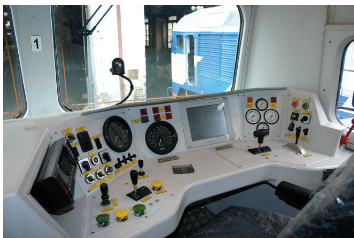
Pulpit maszynisty w nowej kabinie lokomotywy ST44
