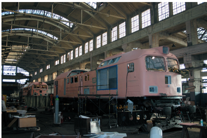
Montaż podzespołów na modernizowanej lokomotywie ST44
