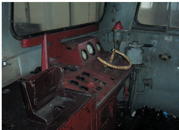
Kabina maszynisty lokomotywy ST44 przed modernizacją
