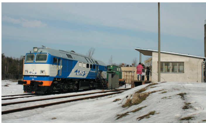
Próby zmodernizowanej lokomotywy ST44 3000 na oporniku wodnym w BUMAR-FABLOK S.A.
