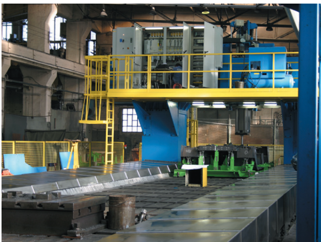
Frezarka bramowa CNC o przestrzeni roboczej 24×3,2×2,5 m
