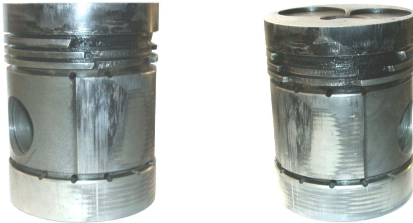
Rys. 1. Uszkodzenia tłoka spowodowane spalaniem stukowym [1]. Fig. 1. Piston damage caused by knock combustion [1].
