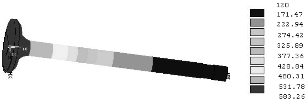
Fig. 7. Temperature distribution in a bimetallic valve [°C] Rys. 7. Rozkład temperatur w zaworze bimetalowym [°C]
