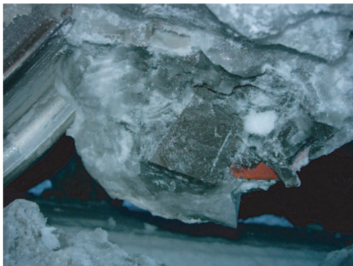
Rys. 7. Oblodzenie klocków hamulcowych z organicznymi wstawkami kompozytowymi typu K podczas badań hamulcowych w warunkach zimowych w północnej Szwecji; widoczna warstwa lodu między kołem i wstawkami [2]
