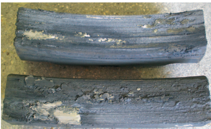
Rys. 3. Wygląd wstawek z materiału typu K, skłonnego do tworzenia wtrąceń metalicznych, po badaniach stanowiskowych według programu nr 4 „Powstawanie wtrąceń metalicznych” [2]
