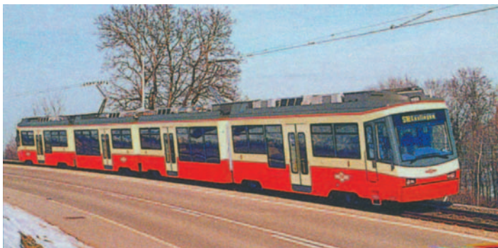
Fot. 1. Lekki pojazd szynowy produkcji Stadler, stanowiący inaugurację tej firmy na rynku tego typu pojazdów; są to dwa zespoły o łącznej długości 24 m, złączone końcami
