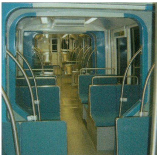
Fot. 4. Pojazd Avanto S70, produkcji Siemens dla Huston ma wnętrze typowe dla lekkich pojazdów trakcyjnych w USA; widoczna jest część niskopodłogowa
