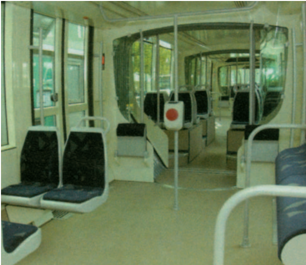
Fot. 9. Barcelona rozpoczęła jazdy próbne tramwaju Citadis 302, produkcji Alstom, zakupionego w ramach projektu TramBaix; ma on szerokość 2650 mm, a wysokość wewnętrzna przegubowego przejścia wynosi 2010 mm
