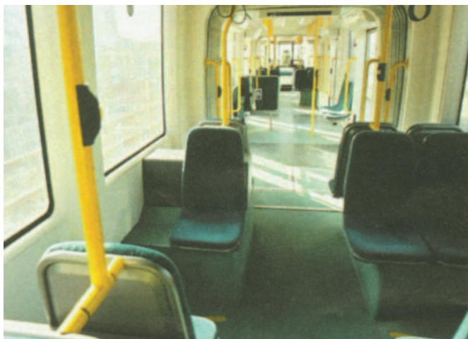
Fot. 11. Na linii Express Transit w Nottingham, W. Brytania, wprowadzono 15 tramwajów typu Incentro, produkcji Bombardier; mają one 54 stałe i 8 składanych miejsc do siedzenia oraz proste wyposażenie wewnętrzne
