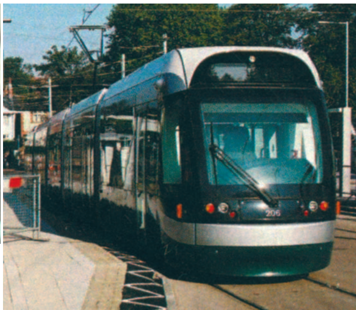
Fot. 11. Na linii Express Transit w Nottingham, W. Brytania, wprowadzono 15 tramwajów typu Incentro, produkcji Bombardier; mają one 54 stałe i 8 składanych miejsc do siedzenia oraz proste wyposażenie wewnętrzne
