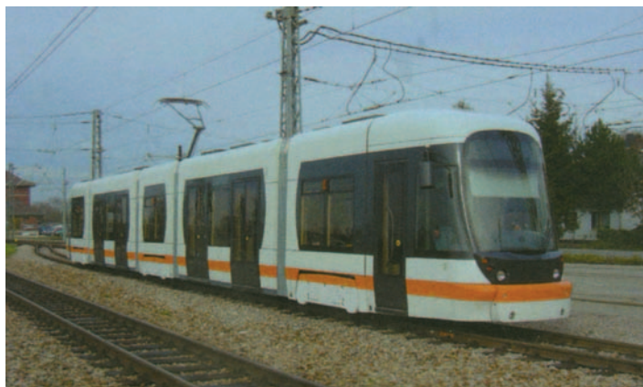
Fot. 13. Tramwaj typu Cityrunner, produkcji Bombardier dla Eskisehir, Turcja, w czasie prób na linii przedsiębiorstwa OEG, Edingen – Mannheim, Niemcy
