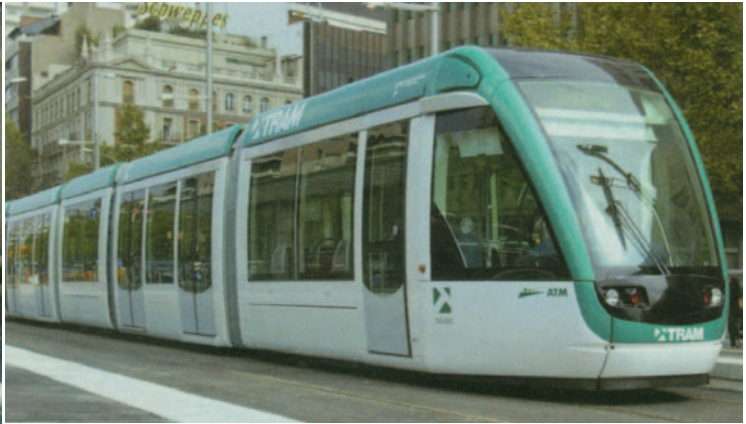
Fot. 9. Barcelona rozpoczęła jazdy próbne tramwaju Citadis 302, produkcji Alstom, zakupionego w ramach projektu TramBaix; ma on szerokość 2650 mm, a wysokość wewnętrzna przegubowego przejścia wynosi 2010 mm
