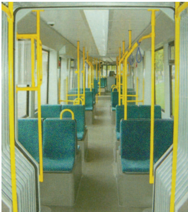
Fot. 6. Wnętrze pojazdu Classic LF 2000, na wózkach produkcji Bombardier dla Frankfurtu nad Menem; zastosowano 4 siedzenia w jednym rzędzie w pojeździe szerokości 2400 mm
