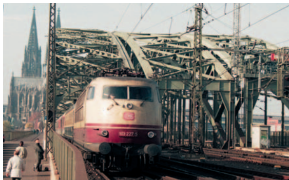
Pierwsze pociągi kolei niemieckich, jadące z prędkością 200 km/h były prowadzone lokomotywami serii 103 (dawniej E03)
