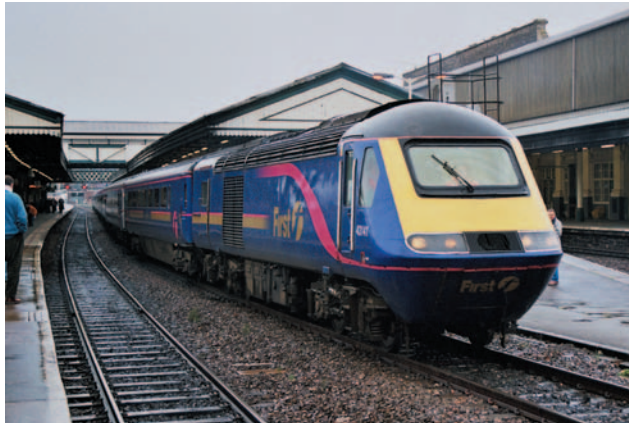
Spalinowe pociągi dużych prędkości (HST) były pierwszymi składami, rozwijającymi w normalnej eksploatacji prędkość 200 km/h w Wielkiej Brytanii (foto z 2003 r.)
