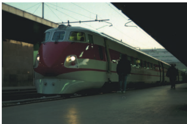
Elektryczne zespoły trakcyjne „Pendolino” serii ETR 450 były pierwszymi (poza prototypowym ETR 401) włoskimi pociągami z przechylnymi pudłami – stacja Roma Termini, marzec 1993 r.
