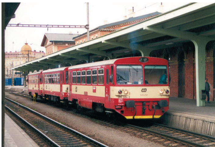
Fot. 5. Typowy pociąg regionalny kolei czeskich ČD, złożony z pojazdów serii 810 i wagonu doczepnego, wyjeżdża ze stacji Czeski Cieszyn Fot. A. Massel
