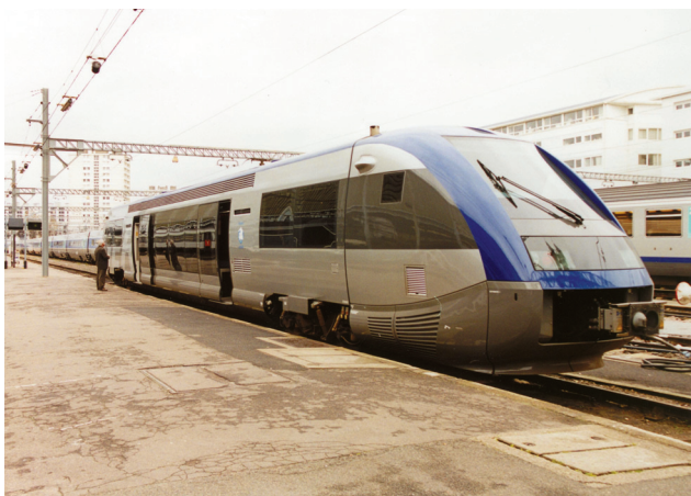
Fot. 1. Francja – zespoły spalinowe Z-TER do obsługi nieelektryfikowanych linii o małych przewozach
