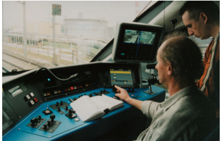
Kabina maszynisty – po prawej stronie monitor do obserwacji peronu
