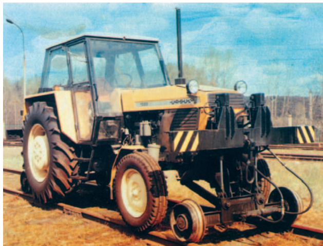
Fot. 4. Ciągnik szynowo-drogowy URSUS
