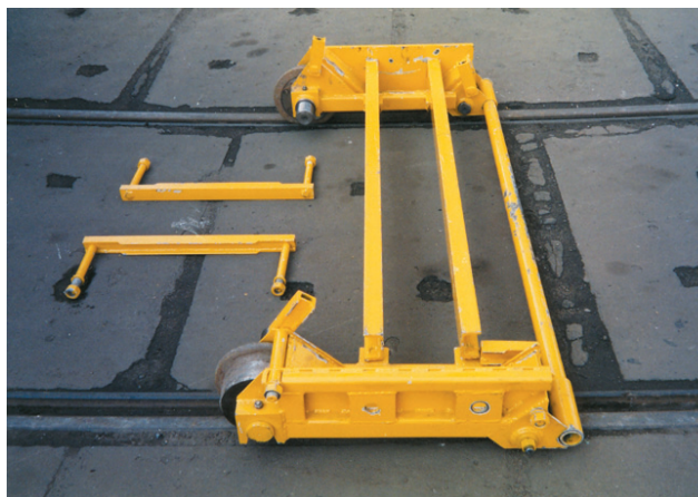
Fot. 14. Wózek awaryjny do transportu tramwajów z uszkodzonym układem biegowym
