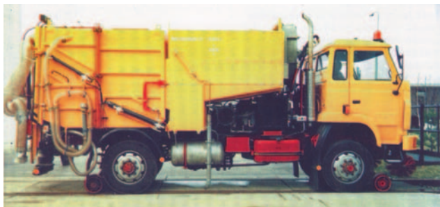
Fot. 18. Pojazd szynowo drogowy STAR do czyszczenia tunelu metra
