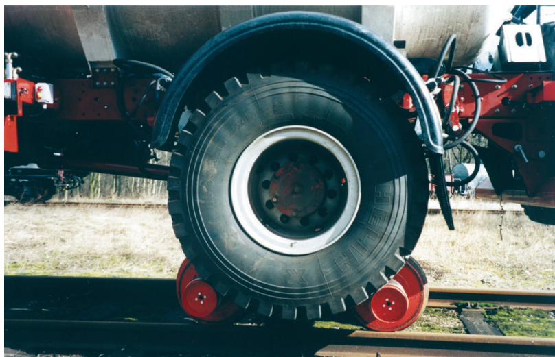
Fot. 2. Szynowy układ jezdny z napędem bębnowym ciernym
