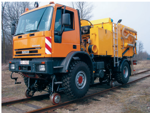
Fot. 20. Pojazd szynowo drogowy IVECO do czyszczenia infrastruktury tramwajowej
