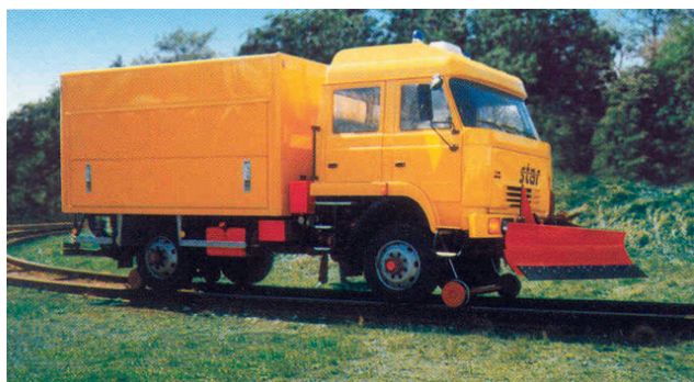
Fot. 13. Pojazd szynowo drogowy UNISTAR do technicznego ratownictwa tramwajowego
