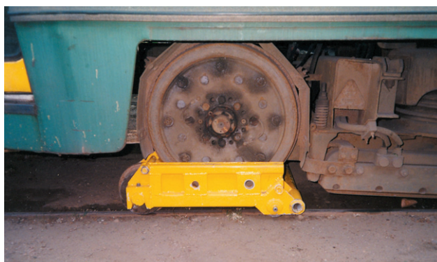
Fot. 15. Wózek awaryjny zamontowany pod tramwajem
