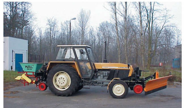
Fot. 5. Ciągnik szynowo-drogowy z pługiem i posypywarką piasku
