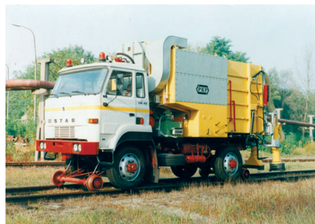
Fot. 17. Pojazd szynowo-drogowy STAR do czyszczenia infrastruktury kolejowej
