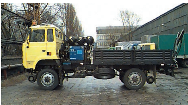
Fot. 10. Pojazd szynowo drogowy STAR do przetaczania ciężkich składów wagonów
