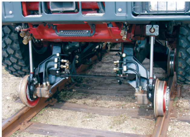
Fot. 3. Szynowy układ jezdny z napędem hydraulicznym
