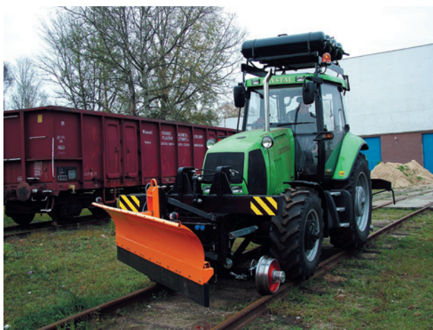
Fot. 9. Ciągnik szynowo-drogowy CRYSTAL na tor normalny i szeroki, wyposażony w pług lemieszowy
