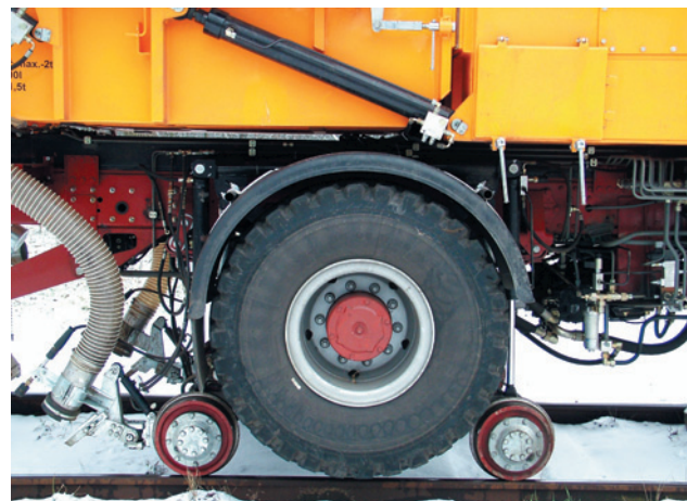
Fot. 22. Widok na skrobak i ssawę
