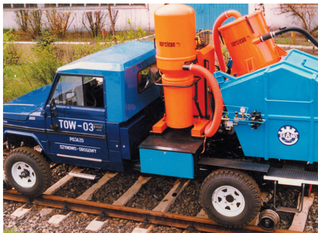
Fot. 16. Pojazd szynowo-drogowy TARPAN-HONKER do usuwania zanieczyszczeń w wagonach towarowych
