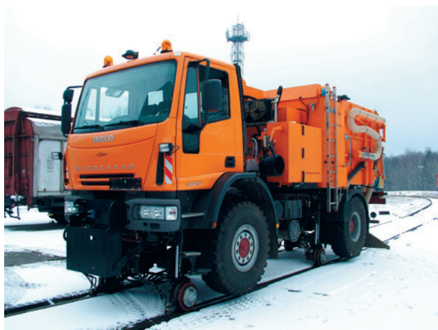
Fot. 21. Pojazd szynowo drogowy IVECO przystosowany do montażu pługa lemieszowego
