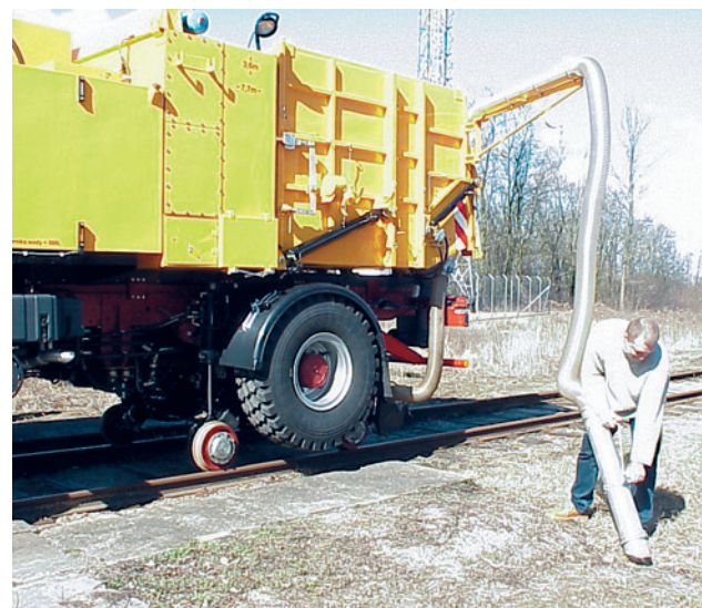
Fot. 23. Wykorzystanie ssawy ręcznej
