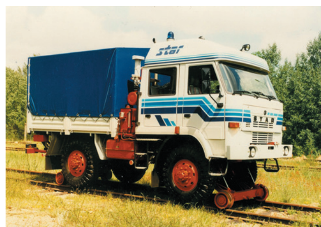
Fot. 12. Pojazd szynowo-drogowy UNISTAR do technicznego ratownictwa kolejowego
