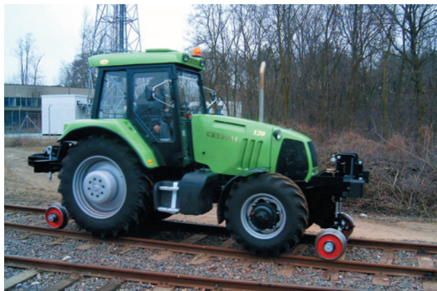
Fot. 7. Pojazd szynowo-drogowy CRYSTAL na tor normalny i szeroki
