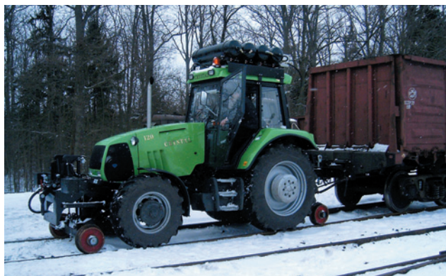
Fot. 8. Ciągnik szynowo-drogowy CRYSTAL na tor normalny i szeroki z hamulcem do hamowania składem doczepionych wagonów
