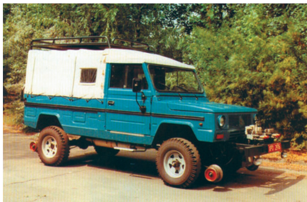
Fot. 11. Pojazd szynowo drogowy TARPAN-HONKER do technicznego ratownictwa kolejowego
