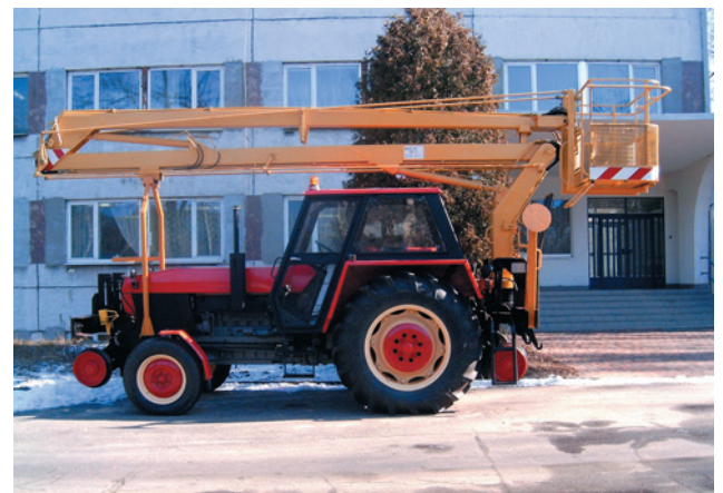
Fot. 6. Ciągnik szynowo-drogowy z podnośnikiem koszowym
