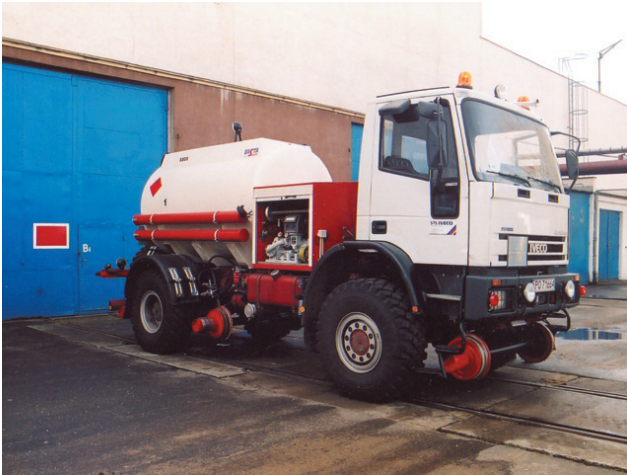
Fot. 24. Pojazd szynowo drogowy IVECO do zaopatrywania w paliwo spalinych pojazdów szynowych
