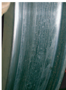
Rys. 4. Zużycie zestawów kołowych po współpracy ze wstawkami żeliwnymi i kompozytowymi zmierzone w trakcie eksploatacji obserwowanej
