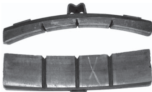
Rys. 5. Wstawki kompozytowe FR502 po eksploatacji obserwowanej w elektrycznych zespołach trakcyjnych
