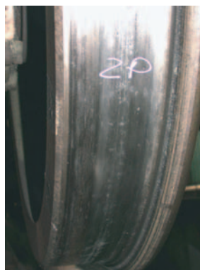
Rys. 6. Powierzchnia toczna obręczy zestawów kołowych po współpracy ze wstawkami żeliwnymi P10 (na górze) i kompozytowymi FR502 (na dole) w trakcie eksploatacji obserwowanej w elektrycznych zespołach trakcyjnych
