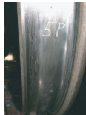
Rys. 6. Powierzchnia toczna obręczy zestawów kołowych po współpracy ze wstawkami żeliwnymi P10 (na górze) i kompozytowymi FR502 (na dole) w trakcie eksploatacji obserwowanej w elektrycznych zespołach trakcyjnych
