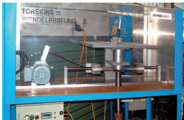
Test na skręcanie w laboratorium HUBER+SUHNER AG
