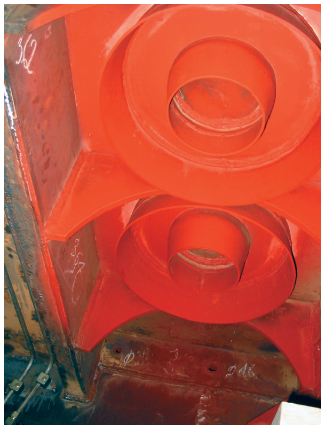
Siedzenia pod sprężyny typu „flexicoil” w trakcie montażu
