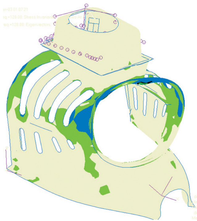
Rys. 9. Postać drgań własnych dla częstotliwości 86 Hz
