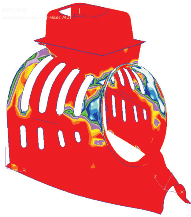
Rys. 10. Kolory obrazują długość życia w skali liczby cykli; największa trwałość dla koloru czerwonego, najmniejsza dla białego
