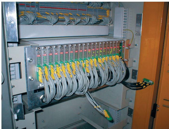
Fot. 1. Sterownik mikroprocesorowy zamontowany w lokomotywie Fot. M. Nawara
