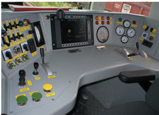
Fot. 3. Pulpit maszynisty z ekranem panelu operatorskiego Fot. M. Nawara
