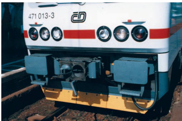
Fot. 11. Sprzęg automatyczny umożliwia automatyczne sprzęgnięcie przewodów elektrycznych i pneumatycznych, rozsprzęgnięcie następuje również automatycznie za pomocą przycisku na pulpicie maszynisty
