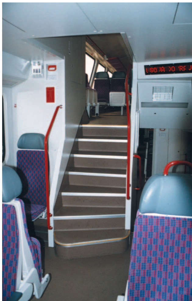
Fot. 7. Schody wejściowe na pokład górny
