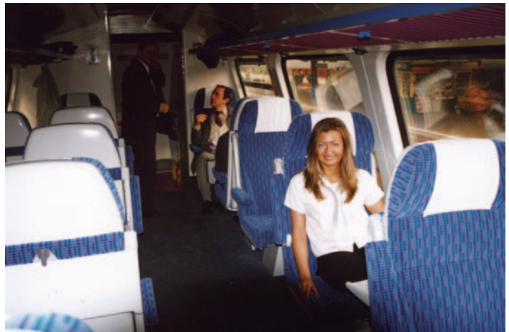
Fot. 8. Przedział 1 klasy znajduje się wyłącznie na górnym piętrze wagonu napędowego; siedzenia orientowane są za sobą i naprzeciwko siebie, półki na bagaż umieszczono wzdłuż ścian wagonu
