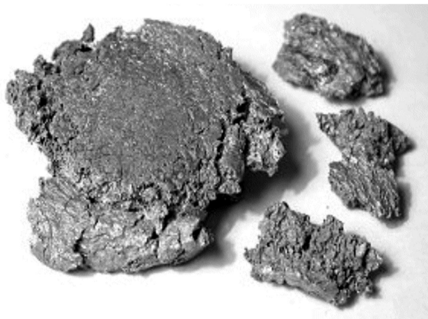
Rys. 12. Odsztatcona próbka ze spienionego siluminu
