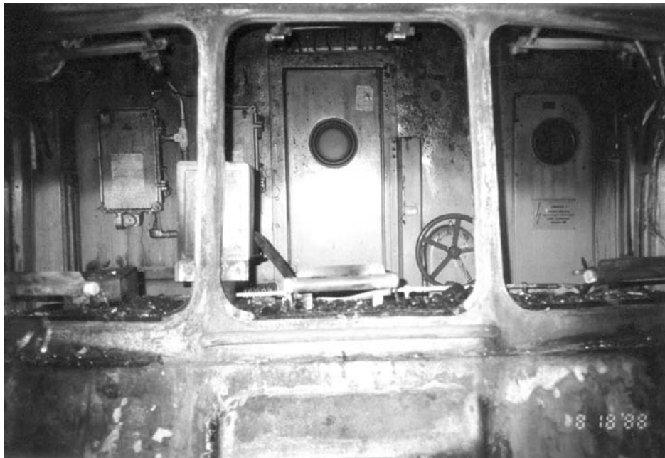
Rys. 4. Spalona kabina maszynisty
