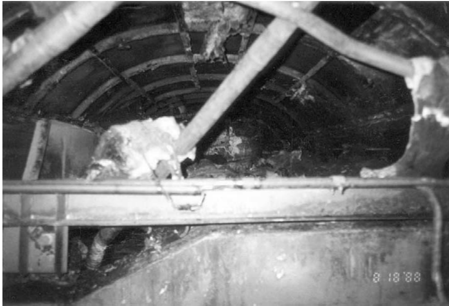
Rys. 8. Spalone wnętrze wagonu – całkowicie wypalone wyłożenie sufitu, łącznie z izolacją
