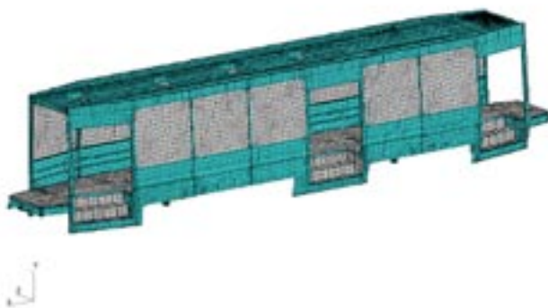
Rys. 2. Model elementów skończonych podłogi tramwaju 105N2k/2000
