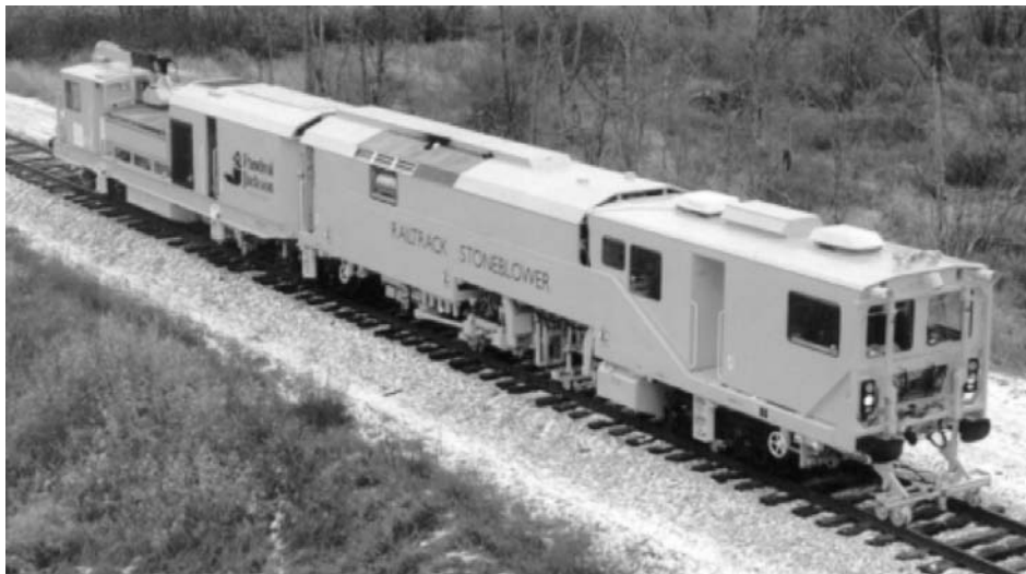
Rys. 5. Brytyjski STONEBLOWER do odmierzonego podsypywania ciśnieniowego
