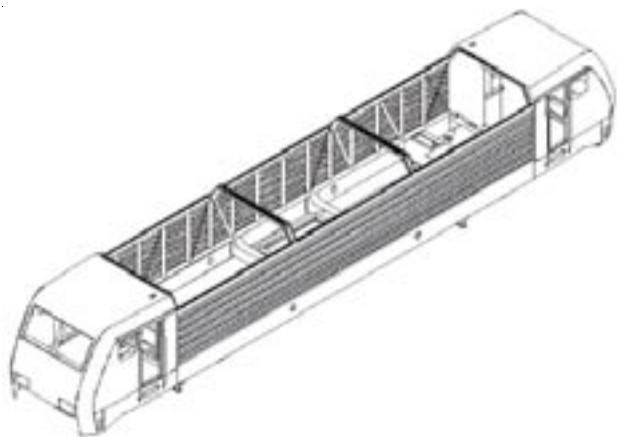
Rys. 6. Konstrukcja szkieletu surowego pudła lokomotywy (od góry, bez blach podłogowych w maszynowni)
