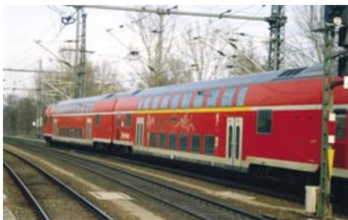
Fot. 4. Pociąg linii RE1 na stacji Berlin ZOO. Popularność linii spowodowała konieczność dokupienia nowych wagonów piętrowych i wydłużenia składów do 5 - 6 wagonów w układzie push-pull z lokomotywą. Prędkość maksymalna pociągów tej linii wynosi 160 km/h Fot. J. Raczyński
