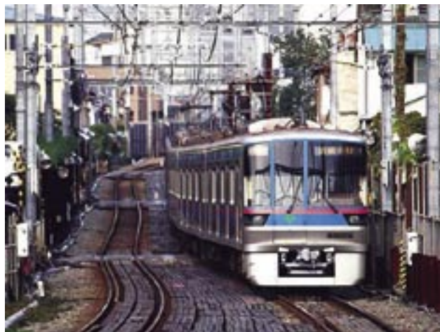
Fot. 4. Tokio – linia Meguro kolei Tokyu, połączona z siecią metra (linie Eidan Namboku i Toei Mita), trasa dawnego „interurban”, wygrodzona z przestrzeni ulicy, z gęsto (jak widać) umieszczonymi przejściami dla pieszych; na zdjęciu pociąg metra Toei Mita
