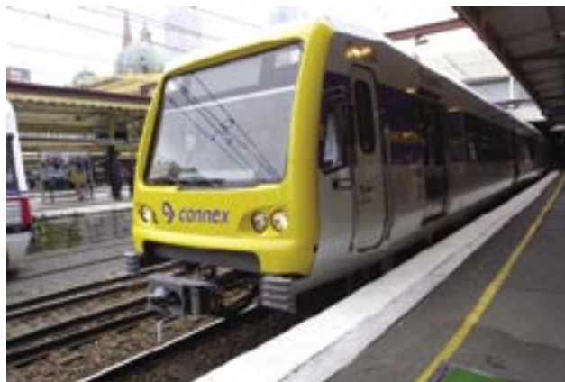
Fot. 9. Melbourne – szerokotorowy system stolicy stanu Victoria nie stosuje wagonów piętrowych; na zdjęciu zespół „X'tropolis” firmy Alstom z 2002 r. przeznaczony dla kolei Connex Fot. Alstom
