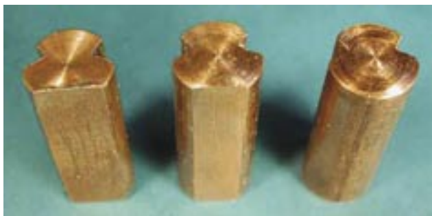
Fot. 4. Próbkę przewodu jezdnego CuAg0,1 : od prawej – próbka nowa, po 10 i 20 tysiącach km drogi tarcia
