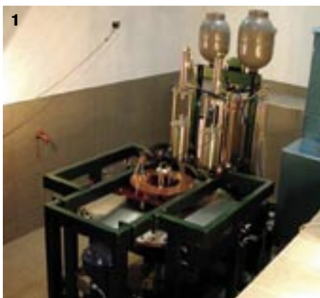
Fot. 5. Widok ogólny stanowiska do badań ścieralności przewodu jezdnego 1 – ujęcie z przodu, 2 – ujęcie od tyłu
