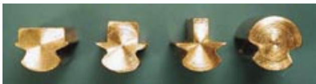
Fot. 3. Przykładowe rodzaje próbek przewodów jezdnych poddanych badaniom odporności na ścieranie
