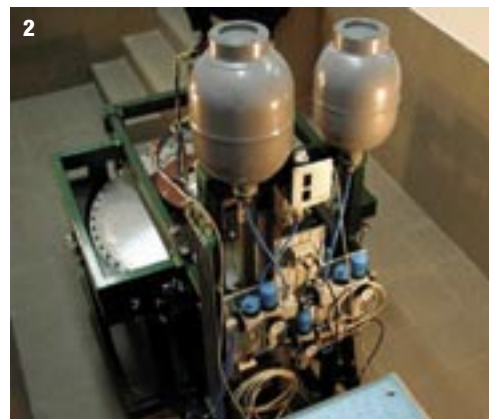
Fot. 5. Widok ogólny stanowiska do badań ścieralności przewodu jezdnego 1 – ujęcie z przodu, 2 – ujęcie od tyłu
