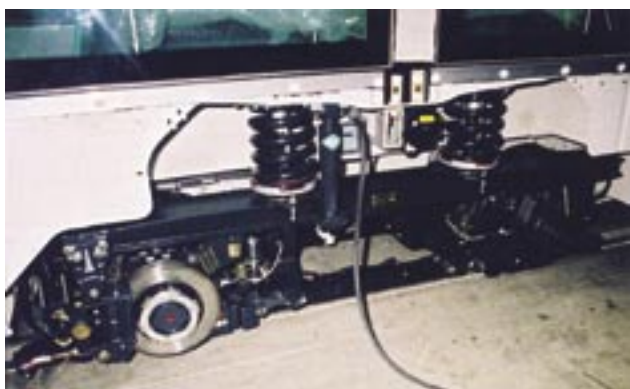
Rys. 41. RET, Rotterdam; Citadis 302 B, zespół jezdny toczny, zbudowany w zasadzie jak zespół napędny bez silnika
