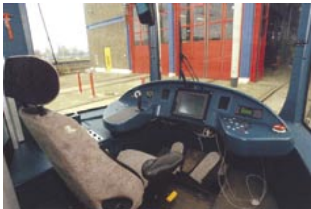
Rys. 43. RET, Rotterdam; Citadis, kabina motorniczego ze standardowym pulpitem sterowania
