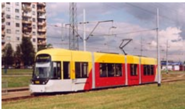
Rys. 6. Bombardier Cityrunner Łódź; długość pojazdu 30 m, szerokość 2,3 m Fot. Ł. Stefańczyk
