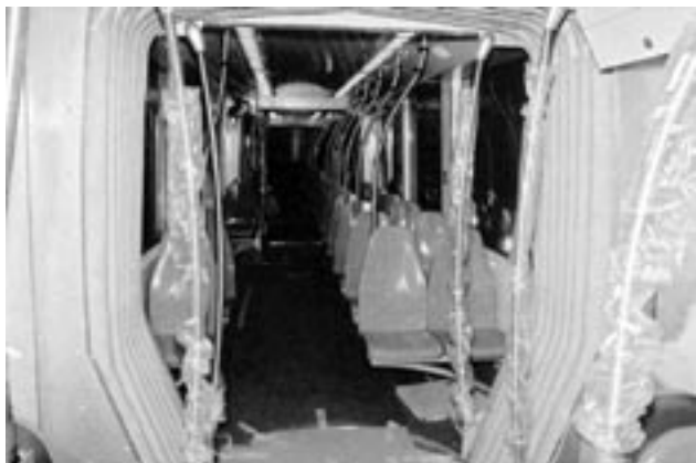
Rys. 39. RET, Rotterdam; Citadis 302 B, falisty mieszek przegubu ze wspornikami siedzeń w lektyce
