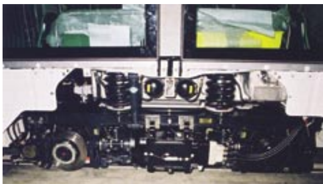
Rys. 40. RET, Rotterdam; Citadis 302 B, zespół jezdny napędny, widoczny jest dobry dostęp do elementów napędu; uresorowany silnik, wał napędowy z łukowym sprzęgłem zębatym, które napędza przekładnię kątową; jedna tarcza hamulcowa na stronę, oś zamocowania przegubowego; resorowanie pierwotne gumowo-metalowe, resorowanie wtórne na sprężynach stalowych, zbiornik oleju hydraulicznego
