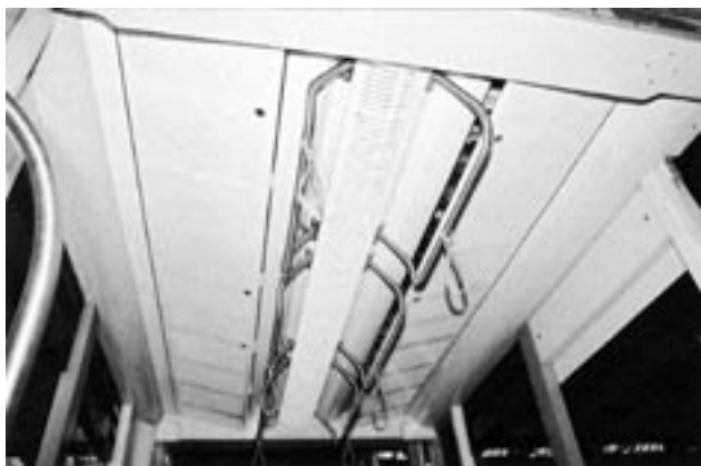
Rys. 50. EVAG, Erfurt; Combino w wykonaniu 5-członowym; konstrukcja tłumiąca hałas – otwór sufitowy, za nim materiał tłumiący dźwięk
