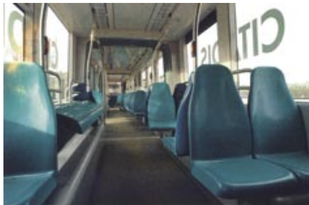
Rys. 42. Różne rozwiązania rozmieszczenia miejsc do siedzenia i stania ponad zespołem jezdnym z dwustronnym napędem wzdłużnym
