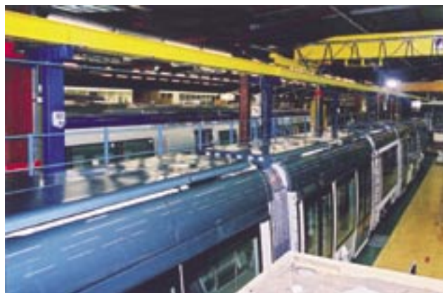
Rys. 30. CUB, Bordeaux; Citadis 402 na stanowisku montażu końcowego, ostanianie dachu
