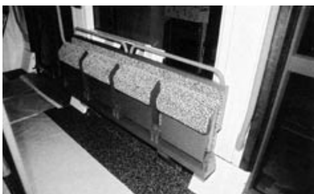
Rys. 23. RATP, Paryż; Citadis 302, powierzchnia lektyki przewidziana jako miejsce do stania z zamontowanymi dodatkowymi siedzeniami uchylnymi
