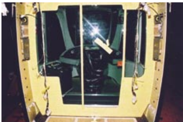
Rys. 19. RATP, Paryż; kabina motorniczego jest o stopień wyżej niż w zwykłym wykonaniu Citadis 302
