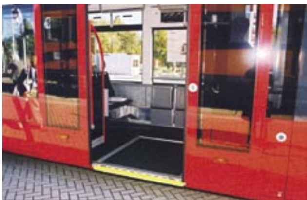
Rys. 56. Bern Mobil; Combino, pomost dla osób niepełnosprawnych na wózkach
