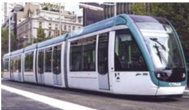
Rys. 34. Citadis 302, wersja dla Barcelony; szerokość 2,65 m
