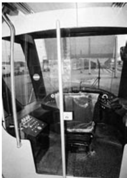
Rys. 27. CUB, Bordeaux; Citadis 302, kabina motorniczego z pulpitem obsługi systemu APS (po lewej)
