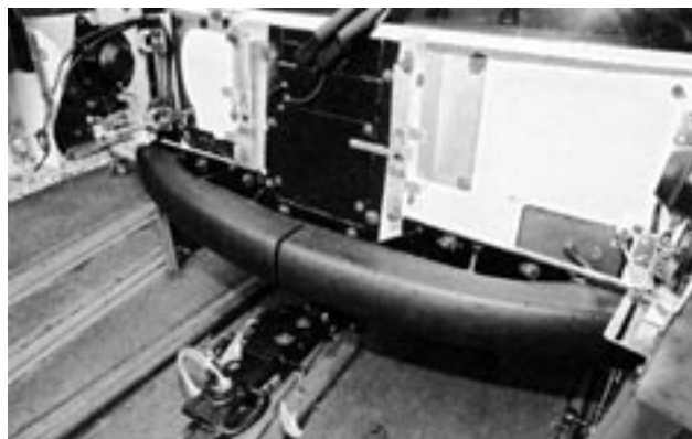
Rys. 54. GVB, Amsterdam; obłożony gumą zderzak, który pozwala na przesunięcie innego Combino bez spowodowania uszkodzeń
