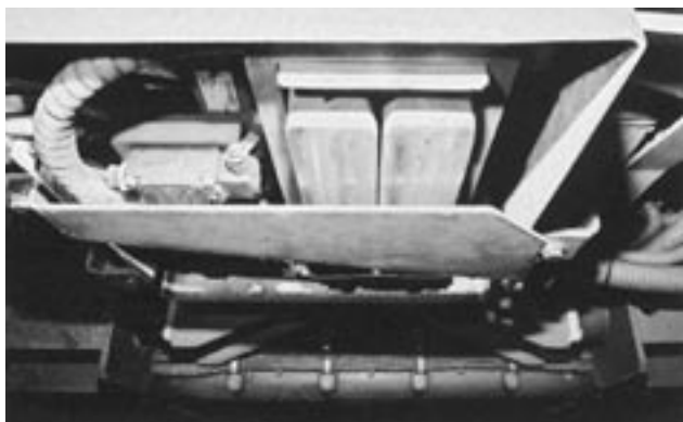
Rys. 13. Odbierak prądu APS jednego z pojazdów dla Bordeaux; jazda z tym systemem zasilania dozwolona jest obecnie tylko na próbnym torze w Bordeaux, ze względu na obowiązujące przepisy odbierak prądu osłonięty jest płytą
