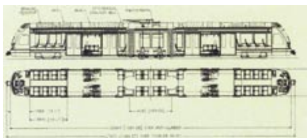
Rys. 11. San Diego Trolley; Avanto S70, szkic wymiarowy
