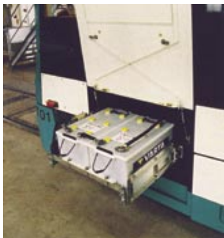
Rys. 26. Kolejka vario, pojemnik z baterią akumulatorów daje się łatwo wysunąć
