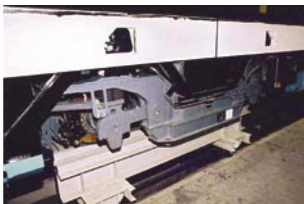
Rys. 24. Kolejka vario, podwozie toczne; po prawej stronie widoczne połączenie przegubowe
