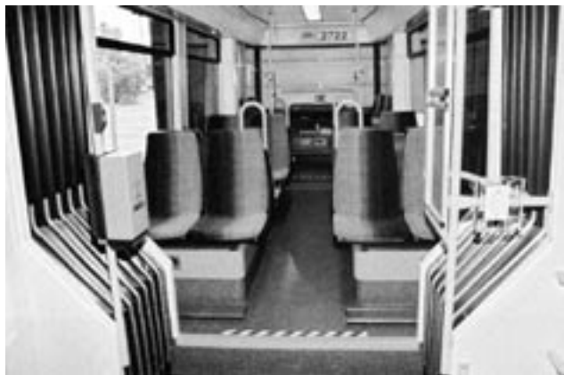
Rys. 18. DVB, Drezno; dostawa pojazdów NGT8DD jest zakończona; wnętrze części wagonowej 7 ze stanowiskiem motorniczego do jazdy wstecz
