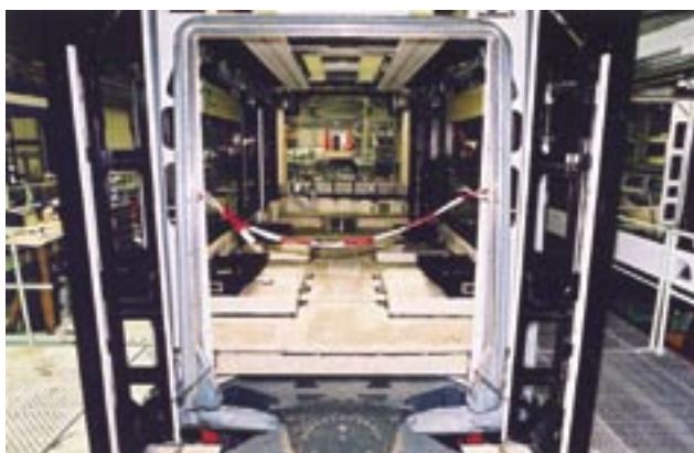
Rys. 21. Kolejka vario Kolei Rhein-Neckar; podwójna harmonia i przegub, element trący przejmuje siły między poszczególnymi częściami wagonowymi pojazdu i wraz z tłumikiem drgań zapobiega kolysaniu poprzecznemu; brak jakichkolwiek wsporników dachowych
