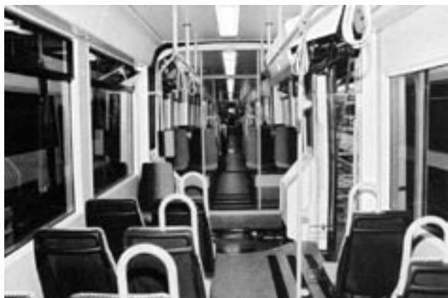
Rys. 19. DVB, Drezno; pojazd NGT8DD, część wagonowa 6 w kierunku części wagonowej 1 – widoczne podwyższenie podłogi z powodu trzeciego podwozia napędowego
