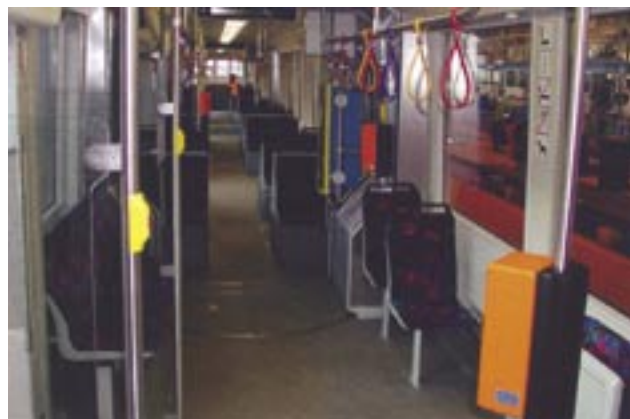
Rys. 5. NVS, Schwerin – w celu pozyskania większej liczby miejsc stojących zmieniony został przedział z miejscami do siedzenia i pewna liczba podwójnych miejsc do siedzenia została zamieniona na pojedyncze; wewnątrz pierwszej części wagonu
