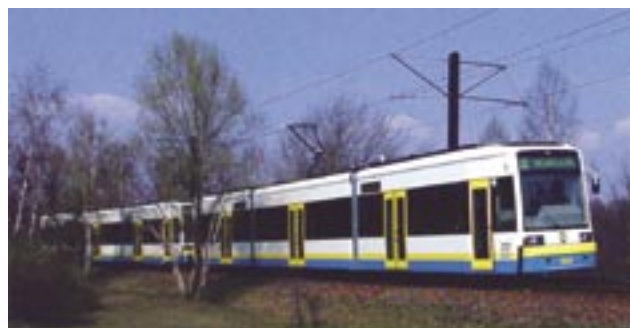
Rys. 4. NSV, Schwerin – nowy pojazd GT8NF o szerokości 2,65 m; podwójna trakcja
