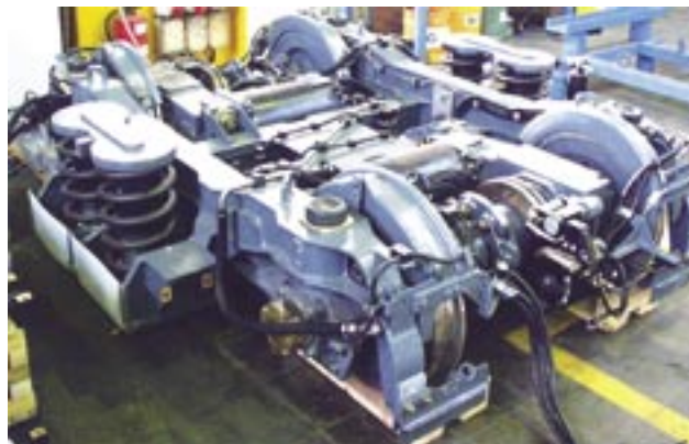
Rys. 22. MVV Verkehr AG, Mannheim; kolejka vario, wózek napędny; wzdłużne połączenie przegubowe zamocowane do dolnego talerza sprężyny
