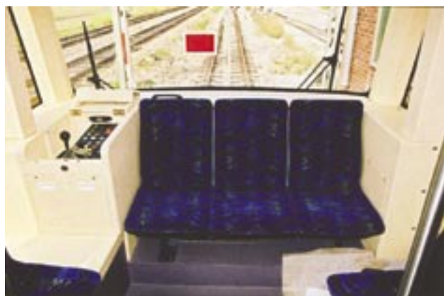
Rys. 31. Kolejka vario – część wagonowa 7, stanowisko motorniczego do jazdy do tyłu
