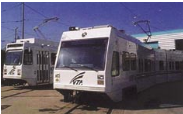
Rys. 14. VTA, San Jose; po lewej jeden z 50 wysokopodłogowych pojazdów Bombardiera, które przeznaczone są do sprzedaży; po prawej pierwszy pojazd o niskiej podłodze serii 100, Kinki Sharyo/Alstom
