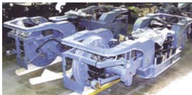
Rys. 23. Kolejka vario, wózek toczny; wzdłużne połączenie przegubowe jest tutaj po wewnętrznej stronie
