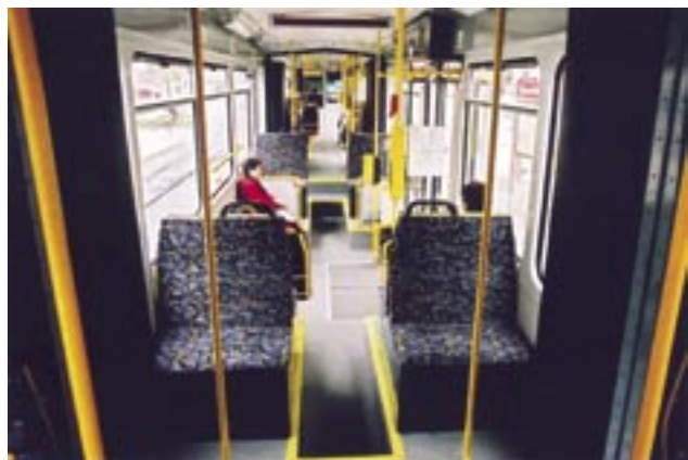
Rys. 3. GVB, Gera; nowy czteroosiowy wagon środkowy z niską podłogą; większość siedzeń posadowiono na podestach
