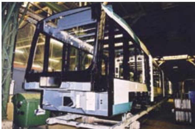
Rys. 20. Przednia część kolejki vario z Mannheim w budowie; Kolej Rhein-Neckar
