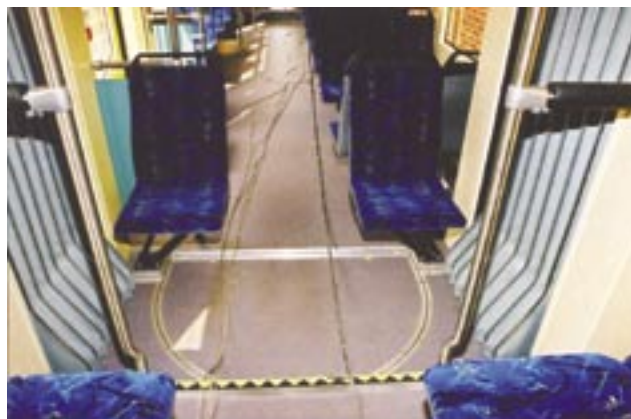
Rys. 30. Kolejka vario; siedzenia montowane w obszarze przegubu, aby zmniejszyć obciążenie od stojących pasażerów
