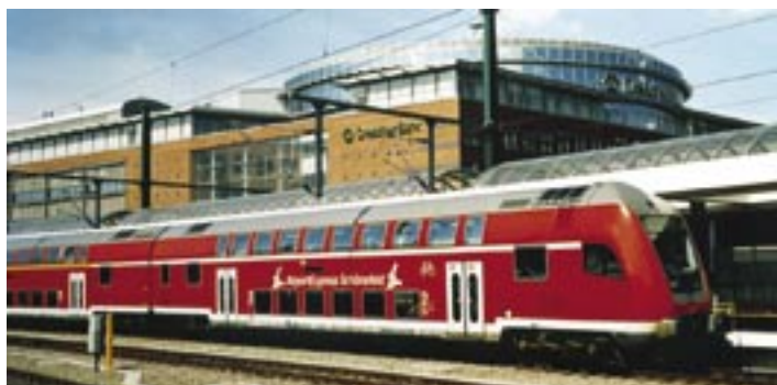
Fot. 8. Pociąg regionalny zestawiony z wagonów piętrowych jako Airport Express Schönefeld
