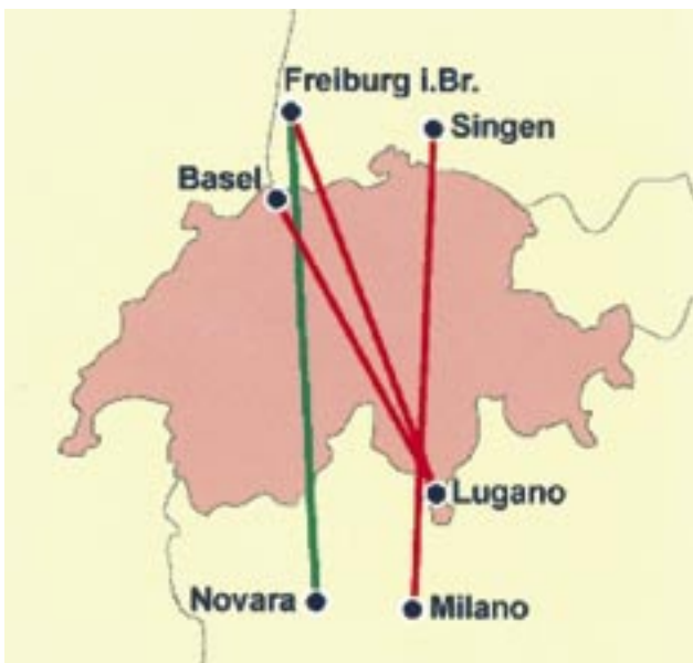
Rys. 3. Trasy pociągów RoLa przez Szwajcarię, kolorem zielonym zaznaczono trasę, na której można przewozić samochody o wysokości 4 m przez Tunel Lötschberg i Simplon, a kolorem czerwonym trasę dla samochodów o wysokości 3,80 m przez tunel Gotthard. Źr. SBB Cargo
