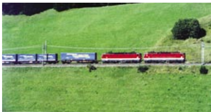
Fot. 2. Najkorzystniejsze dla kolei są przewozy całopociągowe w relacjach bezpośrednich – skład pociągu przewożącego wyłącznie kontenery i skrzynie samochodowe firmy transportowej LKW WALTER prowadzone lokomotywami 1044; na końcu 30-wagonowego składu znajduje się również lokomotywa serii 1044 jako popychacz (St. Jodok 19.08.2002) Fot. R. Rusak
