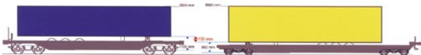
Rys 7. Porównanie skrajni wagonów Sdkms i Saadkmsms – widoczne różnice w możliwościach załadunku naczep samochodowych o różnych wysokościach
