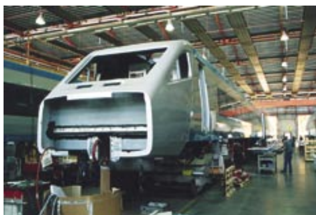
Drugi wagon czołowy pierwszego zestawu 682.001 z jeszcze nie pomalowanym czołem
