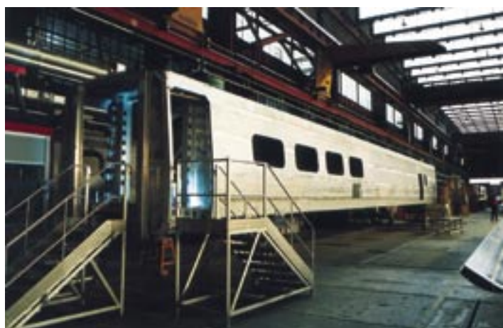
W tej części zakładu kompletowane są pudła; na zdjęciu wagon bufetowy oznaczony serią 683 (konkretnie 683.002); w prawej części zdjęcia widoczna jest ściana boczna wagonu doczepnego angielskiego Pendolino serii 390 dla spółki Virgin z Anglii Fot. T. Kuchta
