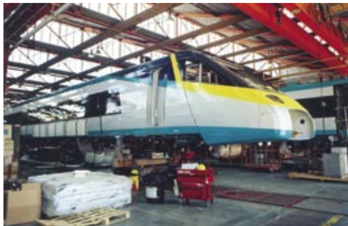
Wagon czołowy czeskiego Pendolino 681.001, którego montaż ukończono jako pierwszy i następnie poddano próbom statycznym Fot. T. Kuchta
