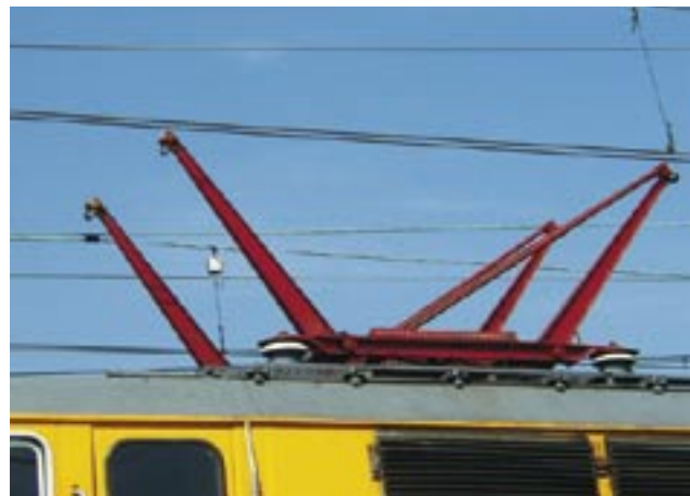
Fot. 5. Uszkodzony odbierak prądu typu 5ZL, listwy ślizgaczu ulegają uszkodzeniu podczas silnych oblodzeń sieci trakcyjnej (ślizgacze innych pantografów też ulegają uszkodzeniu w podobnych warunkach)
