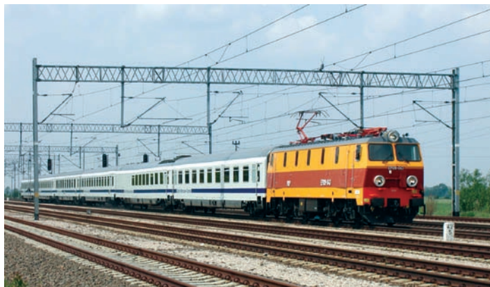
Fot. 4. Lokomotywa EP09 z odbierakami DSA200-PKP
