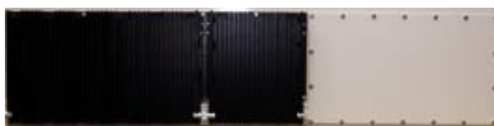
Fot. 1. Przetwornica statyczna wielosystemowa PSM-50W, widok od strony modułów wysokiego i niskiego napięcia
