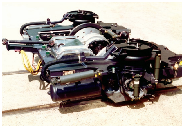
Rys. 13. Wózek zespołów trakcyjnych kolei FS serii TAF
