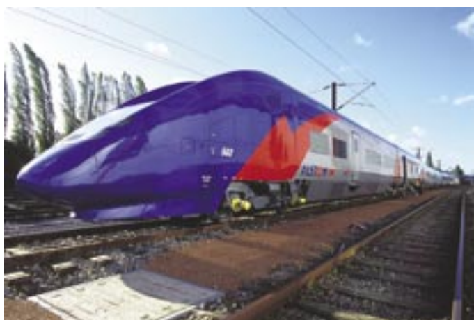
Fot. 1. SNCF przeprowadziły udane próby jazdy z prędkością 320 km/h prototypu pociągu AGV
