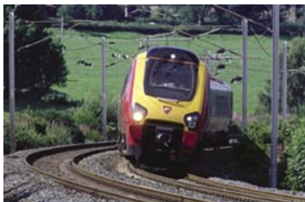
Fot. 6. Zespoły trakcyjne Super Voyager serii 221, które są w eksploatacji obok zespołów serii 220 Fot. Bombardier
