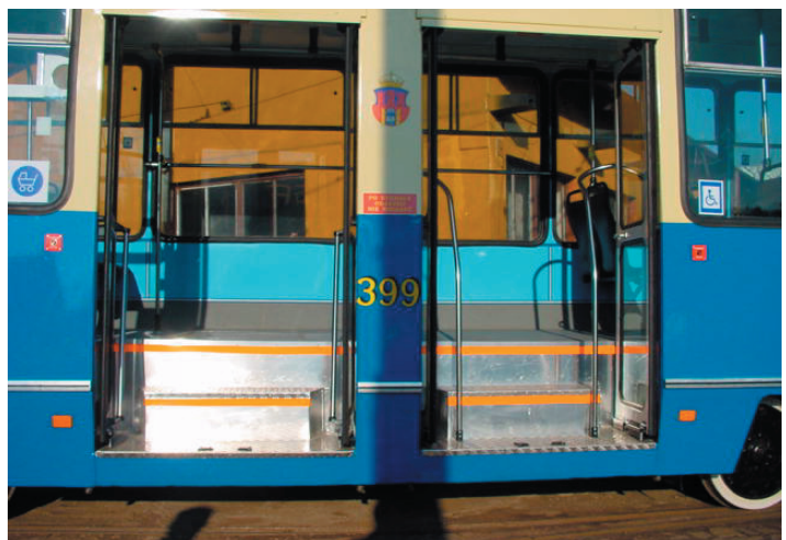
Stopnie wejściowe wyłożone blachą aluminiową. Drugie drzwi wagonu (po prawej) wyposażone w uchwyty dla osób niepełnosprawnych
