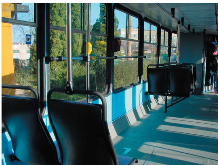
Wykładzina podłogowa wywinięta na ściany pozwala utrzymać czystość tramwaju; wygrodenie części środkowej przeznaczone jest dla wózków i większe bagaże
