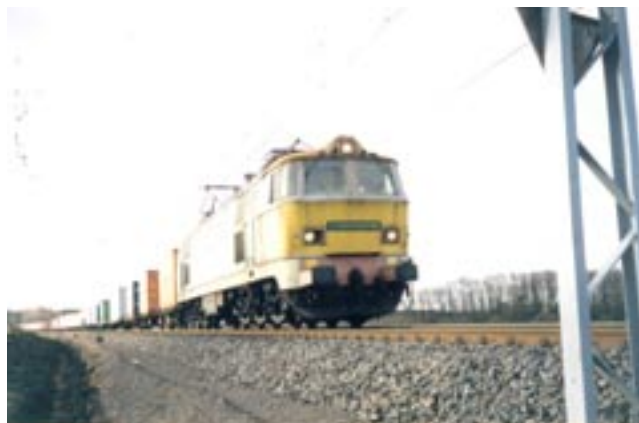
Pociąg towarowy jadący z Oderbrücke w kierunku Kunowic po wyremontowanym torze nr 2 – widoczna nowa sieć trakcyjna o podwójnej linii nośnej, ponad remontowanym torem nr 1 – sieć trakcyjna o pojedynczej linii nośnej; na linii E20 w rejonie Rzepina większość ładunków jest już transportowana w kontenerach na wagonach platformach
