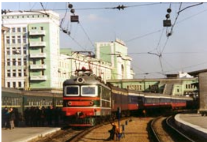
Na odcinkach zelektryfikowanych prądem stałym 3 kV spotyka się lokomotywy produkcji czechosłowackich zakładów Škoda Pilzno z lat 60.; Čs2-294 z pociągiem nr 2 na stacji w Nowosybirsku (3.05.2002 r.) Fot. B. Waga
