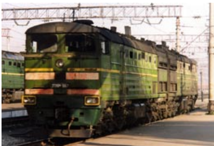
Dwuczłonowa lokomotywa spalinowa 2TE10M-3067 z pociągiem nr 3 po przybyciu do stacji Ulan-Ude; po elektryfikacji brakującego odcinka pociągi na całej trasie prowadzone są wyłącznie lokomotywami elektrycznymi (5.05.2002 r.) Fot. B. Waga
