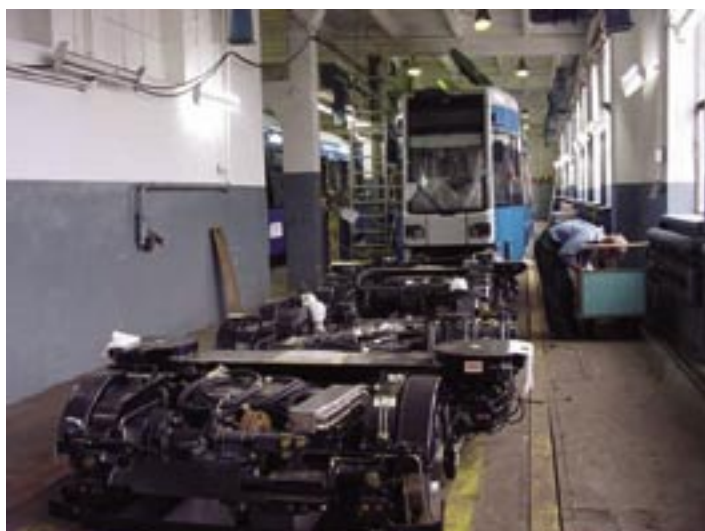
Przygotowanie wózków do montażu, w tle prowadzone są próby statyczne wagonów
