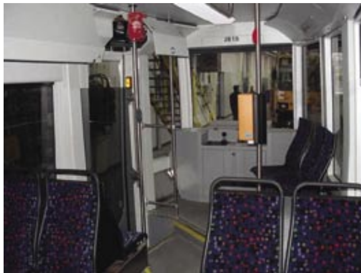
Tylny pomost z nowym wejściem dla pasażerów; w głębi widoczne stanowisko manewrowe
