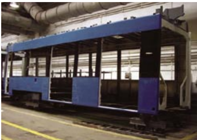
Widok drugiego członu wagonu – początek montażu po przekazaniu pudła do Krakowa
