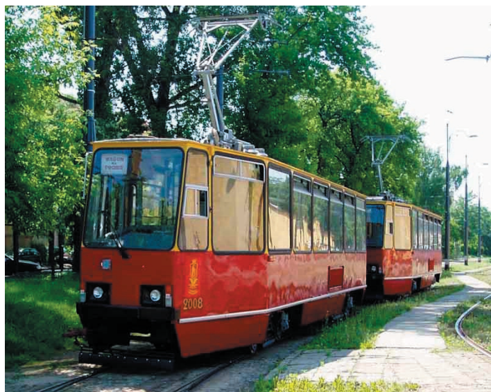
Fot. 1. Tramwaj typu 105N z napędem asynchronicznym
