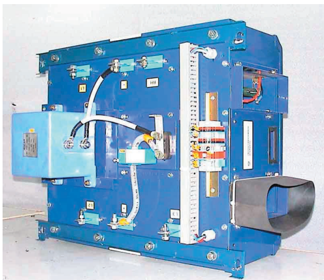
Fot. 2. Falownik układu napędowego
