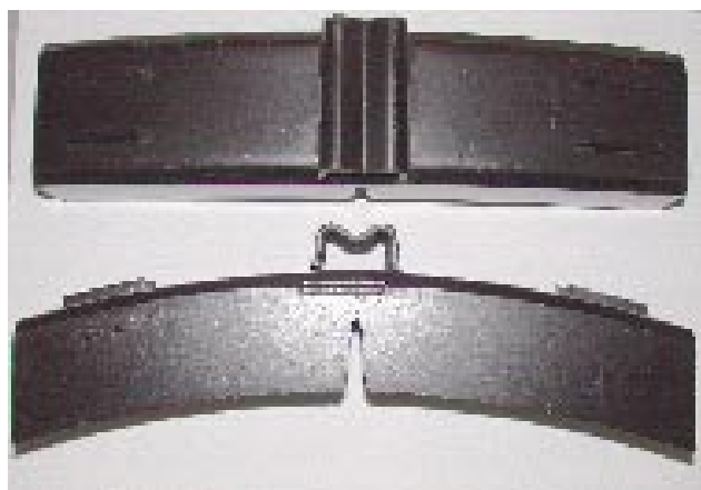
Fot. 1. Kompozytowa wstawka hamulcowa, długości 350 mm, wykonana z materiału FR502
