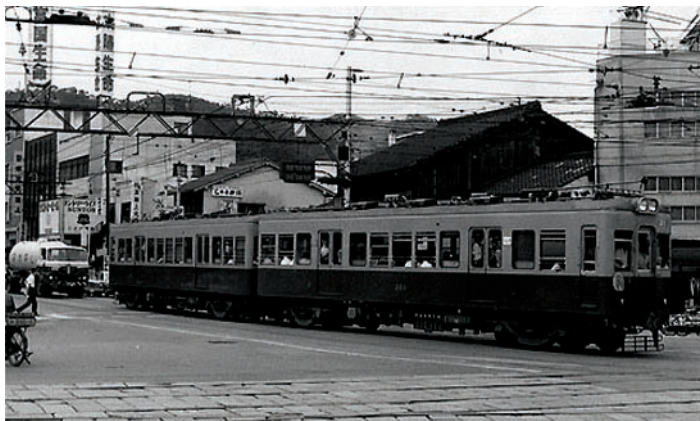
Fot. 4. Kioto – pociąg tokkyū (ekspres) na głównej linii kolei prywatnej Keihan (między Osaką i Kioto), obsługiwany przez EZT typu 1900, przejeżdża jedno z wielu skrzyżowań – tutaj jeszcze z torami tramwajów miejskich; najprawdopodobniej tramwaje miały niższe napięcie, niż kolejowe 1500 V
