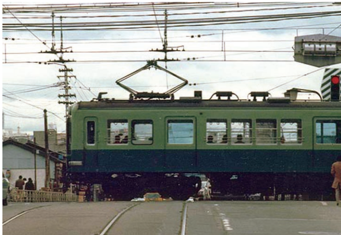
Fot. 13. Otsu koło Kioto – pociąg kolei Keishin na węźle ulicznym z inną linią interurbans ; jednostka typu 260 to typowy tabor o gabarytach „ciężkiej” kolei, ale mogący poruszać się także ulicą; wagony takie musiały być wycofane przez podłączeniem linii do sieci metra w Kioto Fot.: © Kenichi Oto, 1968
