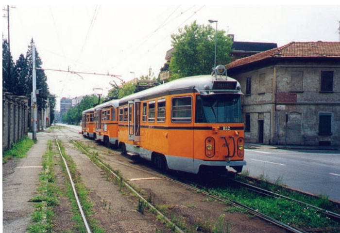
Fot. 5. Mediolan – pociąg na linii do Desio (jednej z dwóch tzw. linii Brianza), zbudowany jako dwusystemowy (600/1200 V) dla linii Adda, która została później włączona w system metra; od 1999 r., ze względu na budowę metra, wjazd do miasta jest dla linii Brianza zamknięty, a pociągi rozpoczynają kursy poza jego granicami; obecnie przewiduje się modernizację i rozbudowę tych raczej zapomnianych linii (zwraca uwagę rozwiązanie przystanku)
