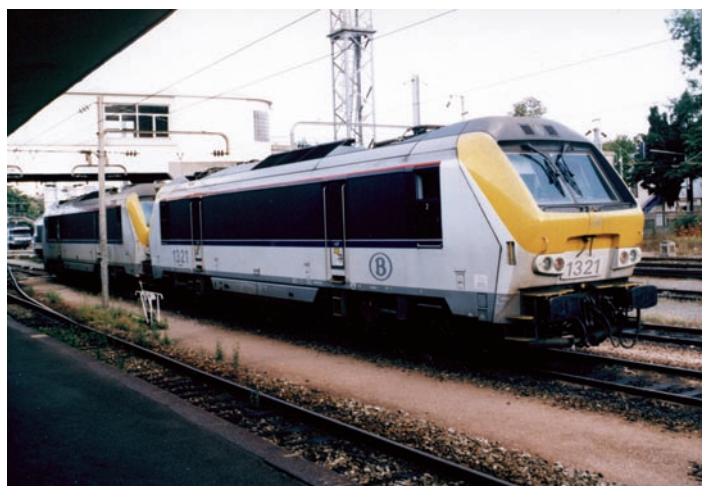
Wielosystemowe lokomotywy SNCF serii 1300 (1321+1305) obsługujące relacje Belgia – Francja (29.07.2003 r.) Fot. D. Gielnik
