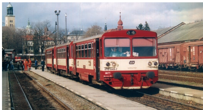
Oprava Vychod, pociągi lokalne obsługiwane są autobusami szynowymi serii 810 – jest to bardzo popularny środek szynowego transportu w Czechach
