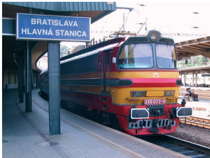
Lokomotywa prądu przemiennego na napięcie 25 kV serii 240 z pociągiem regionalnym na głównym dworcu Bratysławy Fot. J. Goździewicz
