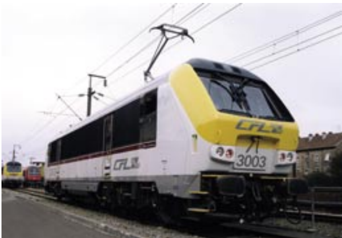
Fot. 6. Lokomotywa uniwersalna kolei CFL serii 3000, identyczna z lokomotywą serii 13 kolei SNCB
