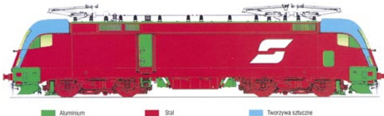
Rys. 21. Materiały konstrukcyjne lokomotywy ÖBB serii 1016/1116
