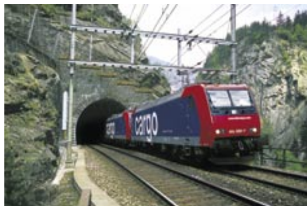
Fot. 9. Lokomotywa serii 184 kolei SBB na bazie lokomotywy serii 185
