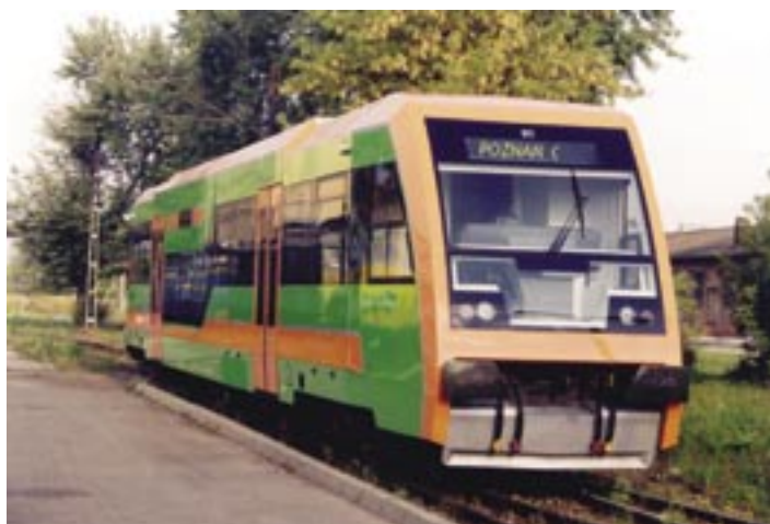
Partner (214M) budowany przez bydgoską PESE to obecnie jedyny typ czteroosiowego wagonu motorowego eksploatowanego na sieci PKP; na zdjęciu prototypowy wagon po dokonaniu niewielkich rekonstrukcji nadwozia Fot. P. Terczyński
