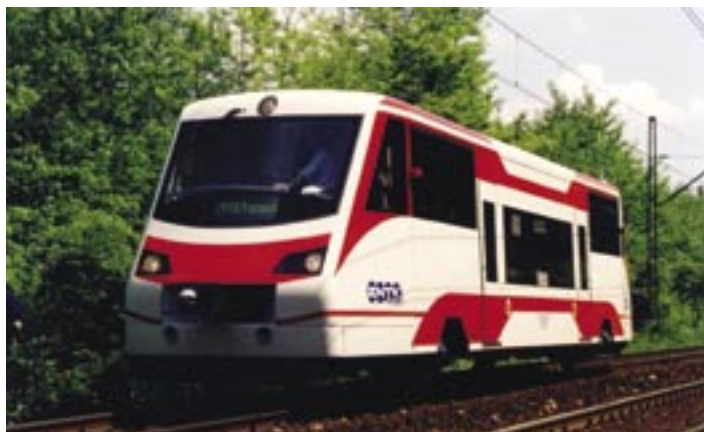
W 2002 r. w ZNTK Poznań zbudowano dwa prototypowe niskopodłogowe wagony typu 213M, dające początek rodzinie pojazdów Regio Tramp , obsługujących obecnie już kilka relacji w Wielkopolsce Fot. P. Terczyński
