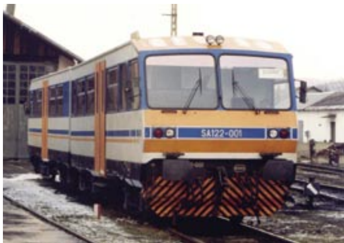
Autobus typu 208M stanowił rozwinięcie konstrukcyjne pojazdów serii SN81; widok od strony wagonu doczepnego Fot. P. Terczyński
