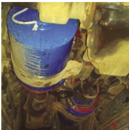
Rys. 3. Dwa silniki typu STDa200L4 zamontowane do wózka
